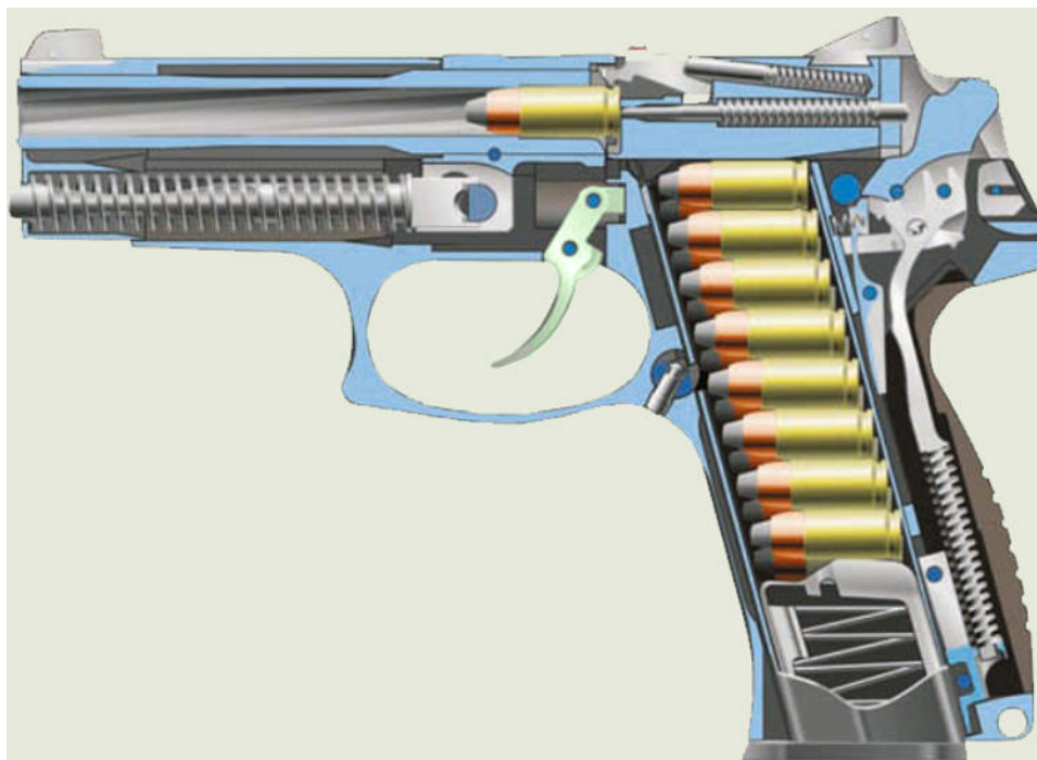
Рис. 2. Положение частей и механизмов пистолета при зарядании
