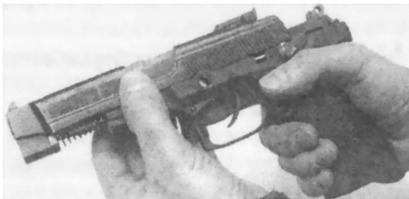
Рис. 44. Отделение затвора со стволом и возвратным механизмом от рамки
