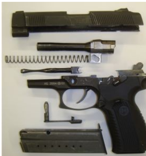
Рис. 47. Пистолета Ярыгина после неполной разборки
