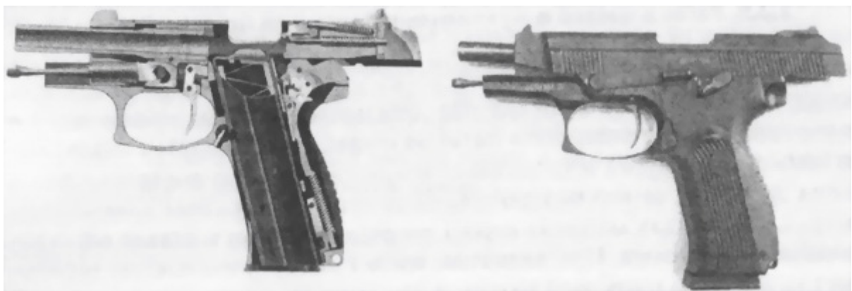
Рис. 4. Пистолет Ярыгина после израсходования всех патронов
