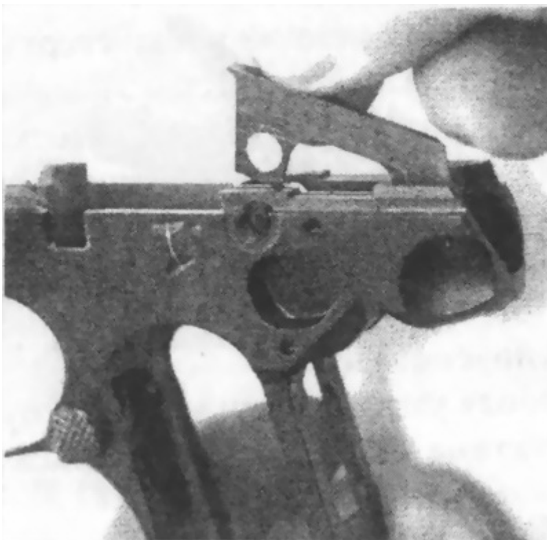
Рис. 81. Присоединение отражателя к рамке пистолета
