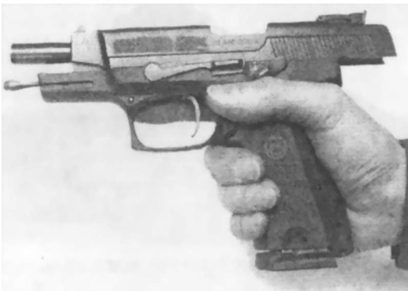
Рис. 55. Отведение затвора в крайнее заднее положение
